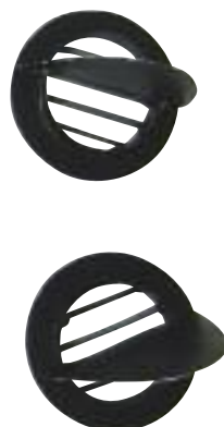
Der 29-mm-Landescheinwerfer; der Blendschutz wurde aus Lithoblech selbst hergestellt.
