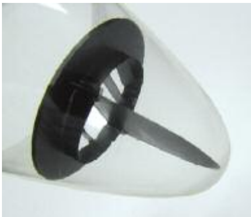
Der Blendschutz wurde sorgfältig an das Glas der Flügelkeule angepasst.
