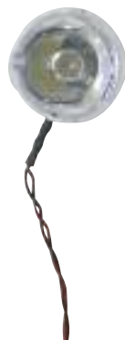
Der 29-mm-Landescheinwerfer; der Blendschutz wurde aus Lithoblech selbst hergestellt.
